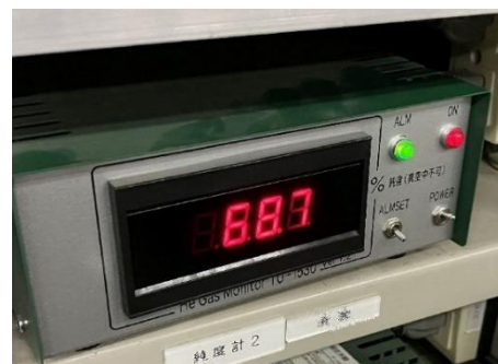
図 5. 2 ヘリウム純度計。普段は100%に近いがこの時は68.7%を示していた。
