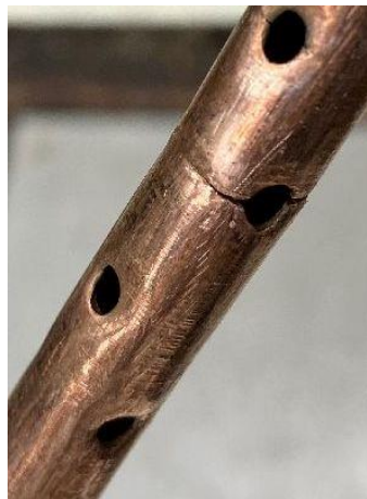
図 4. 1 左と中央が以前の銅製のノズル。中央の写真から穴の位置に亀裂が入っていることがわかる。右は新しいステンレス製のノズル。
