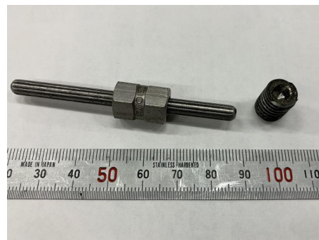
図9.2 左がエクストラクタ。右は取り出した折れたネジ。
