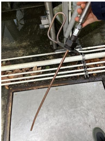
図 4. 1 左と中央が以前の銅製のノズル。中央の写真から穴の位置に亀裂が入っていることがわかる。右は新しいステンレス製のノズル。
