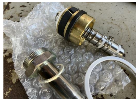
図 4. 2 電磁バルブのパーツ交換。左は交換のため分解したところ。右は新しく購入したパーツ。
