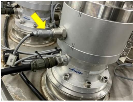
図 3. 2 黄色の矢印で示した部分が温度センサ用のケーブルの端子。その下部にある端子はタービンの回転数用である。
