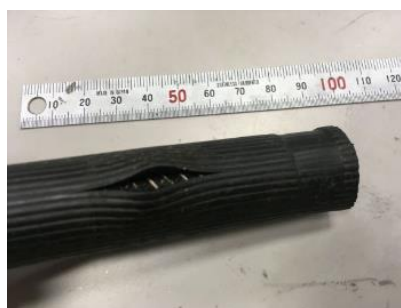
図 2.2.2 裂けたゴムチューブ。
