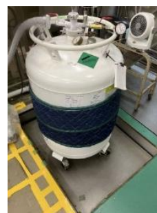
図 6 液体ヘリウム充填場所。充填直後の様子。容器の下にテーブルリフターがある。
