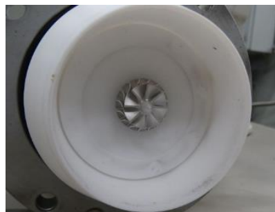
図 3.1.3 下から見たタービン。異常は見られない。
