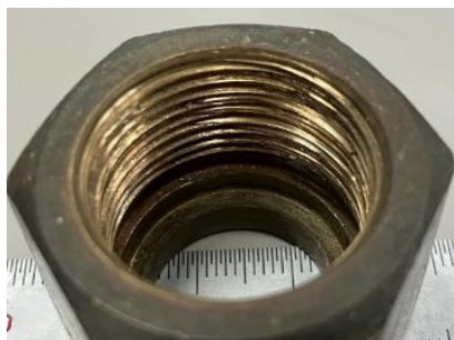
図4.1.2 安全弁を取り付けていた袋ナット。ネジ山が潰れている。
