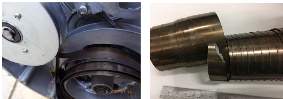
図9 レベル計のスプリング。左は装置についている状態。右は取り外しである。スプリングが裂けているのがわかる。
